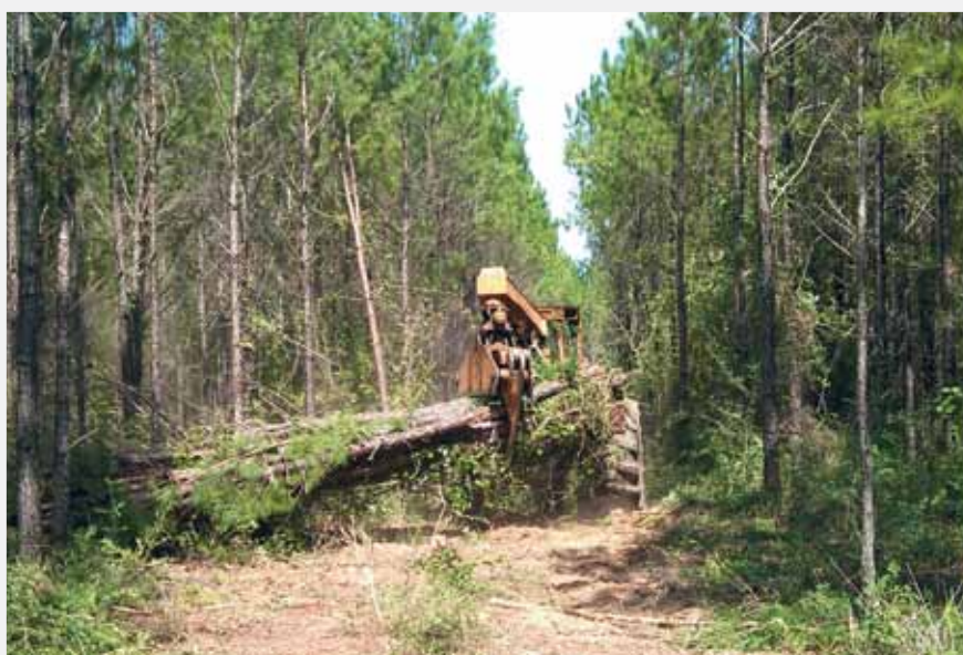
Drivningsmetoderna kan skilja sig avsevärt mellan olika delar av världen. Den lunnare som används för att släpa hela stammar i USA (foto: Fredrik Ingemarson) kan motsvaras av en elefant i Laos (foto: Björn Svensson/SKOGEN bild).
